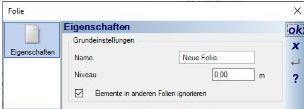
Wenn Sie ihre Auswahl für Elemente und Zielfolie getroffen haben, beenden Sie den Dialog mit OK und der Kopiervorgang beginnt. Die Elemente werden auf der neuen Folie an der gleichen Position erzeugt, an der Sie auch in der Quellfolie waren.
