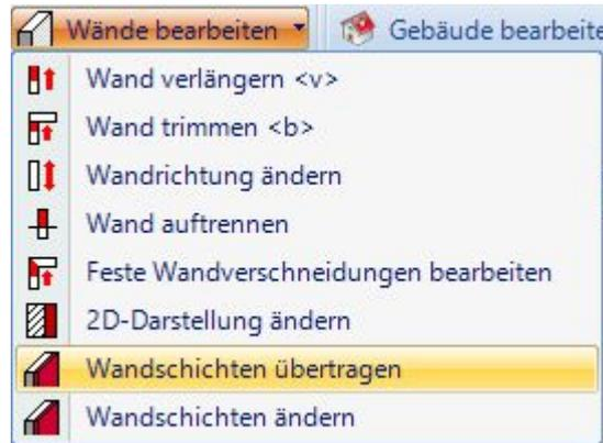
Es folgt in Schritt 1 der Dialog, in dem Sie bei Bedarf den Auswertungsbereich festlegen und aus der Liste der vorhandenen Wandtypen die Ausgangswand wählen, deren Schichtaufbau in der Folge übertragen wird.
